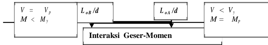
Gambar 4. Spektrum panjang shear link (kiri L_o kecil, kanan L_o besar)
