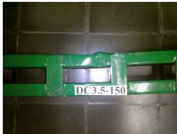
Gambar 3. Kegagalan kolom langsing tanpa pengisi beton ringan
