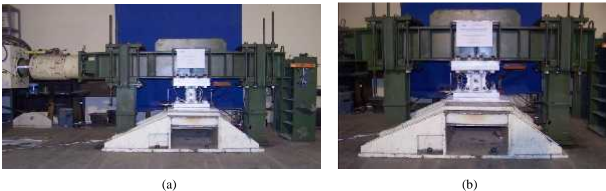
Gambar 2. Setup benda uji pendisipasi energi pipa tegak: (a) Pipa tanpa perkuatan; (b) Pipa dengan perkuatan
