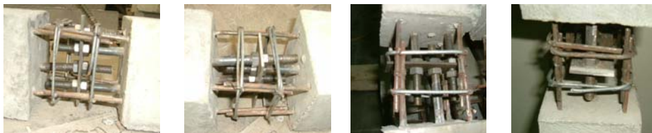
Gambar 15. Detail sambungan baut dan plat hubung
