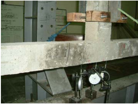
Gambar 8. Retak pertama pada tengah bentang
