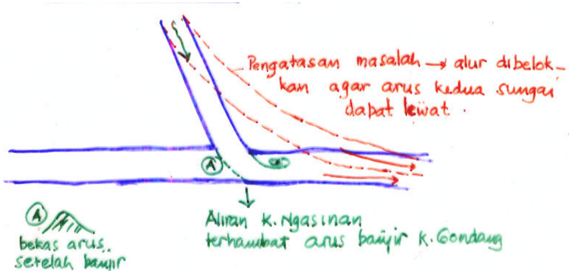
Gambar 3. Kerusakan jalan akibat banjir pada pertemuan sungai
