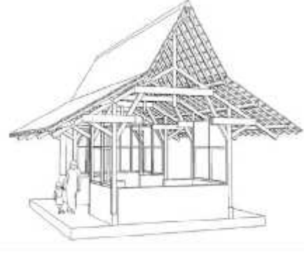
Gambar 3. Dinding bata yang dikombinasikan dengan panel dinding fibercement, Sketsa desain rekonstruksi rumah desa Ngibikan oleh Eko Prawoto Sumber : Brigitte Shim, 2010
