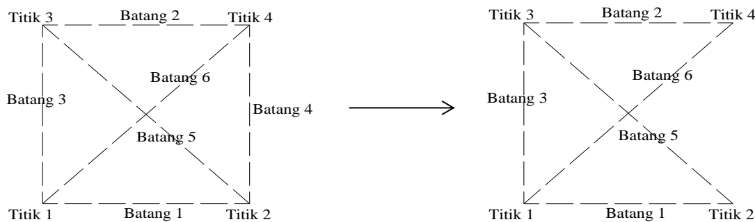
Gambar 1. Kemungkinan batang yang terjadi untuk 4 titik joint
