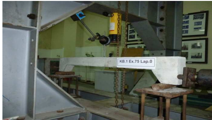
Gambar 1 Setup pengujian kolom dengan beban eksentrik
