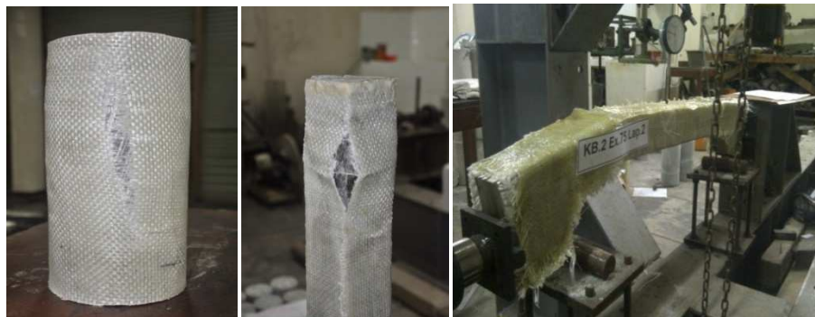
Gambar 7 Pola kerusakan benda uji silinder dan kolom
